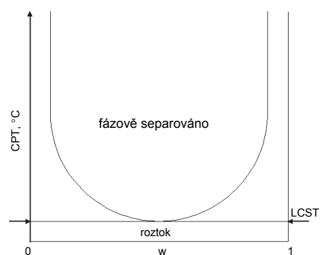
Obr. 1. Závislost teploty fázové separace na koncentraci polymeru v roztoku; CPT – teplota fázové separace; LCST – dolní kritická rozpouštěcí teplota; w – hmotnostní zlomek polymeru v roztoku
