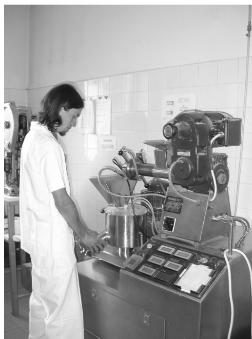
Obr. 1. Výroba pelet extruzí-sferonizací umožňuje získat sférické částice matricového typu až 90% obsahu léčiva a úzkým velikostním rozpětím
