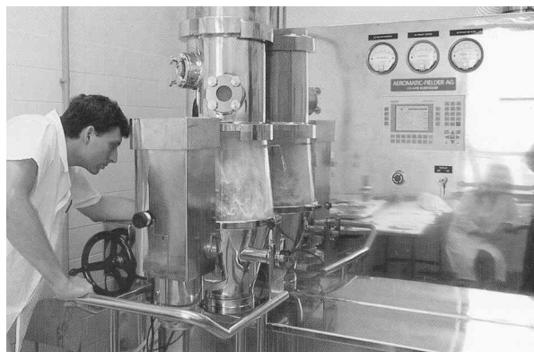
Obr. 2. V rotoprosoru (součást multifunkčního zařízení Multi-processor) lze získat homogenní pelety z prachové směsi léčiva a pomocných látek a současně je opatřit obalem, který může řídit uvolňování aktivní substance. Nová technologie je v ČR ojedinělá, také v mezinárodním měřítku ji studuje pouze několik málo pracovišť
